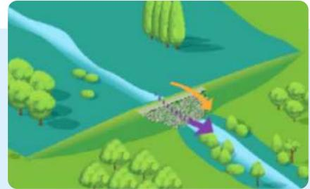
Lors d'une crue centennale, l'eau est stockée en amont de l'ouvrage et s'accumule au-delà de la capacité de stockage de l'ouvrage. L'écoulement se fait alors progressivement par la surverse de sécurité.
