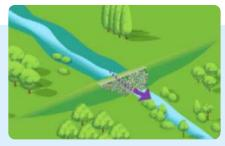
En période de faible crue, l'eau s'écoule dans le lit mineur sans être retenue par l'ORD
