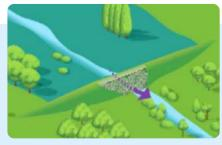
Lors d'une **crue plus importante**, l'eau est stockée temporairement en amont de l'ouvrage. En aval, le débit est réduit et le niveau d'eau est abaissé
