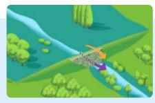
Lors d'une **crue centennale,** l'eau est stockée en amont de l'ouvrage et s'accumule au-delà de la capacité de stockage de l'ouvrage. L'écoulement se fait alors progressivement par la surverse de sécurité.
